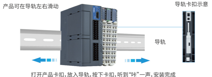
图9 导轨安装
